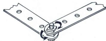
Assemblage de deux pièces leur permettant de pivoter ou de bouger l'une par rapport à l'autre. Ce montage s'appelle « articulation à contre-écrou ». On place un écrou au-dessus et au-dessous d'une des bandes et on les serre contre cette bande. La seconde bande reste libre entre la tête des boulons et l'écrou du dessous.
