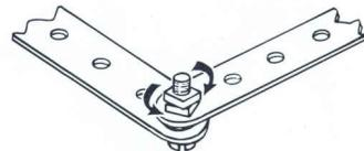
Autre type d'articulation à contre-écrou. Les deux écrous sont serrés l'un contre l'autre. En les tournant en sens opposé les écrous ne doivent pas bloquer les bandes.
