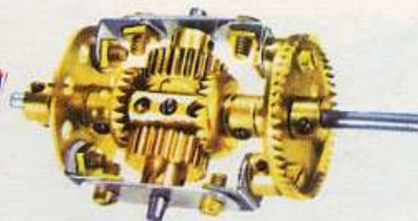
Exemple de DIFFERENTIEL réalisé avec la boîte d'engrenages.
